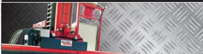
La columna libre de vibración y el brazo pueden utilizarse para posicionar el cabezal de soldadura para la soldadura automatizada de una gran variedad de piezas desde tubería pequeña a grandes tanques. Ambas soldaduras la longitudinal y la circunferencial pueden automatizarse fácilmente usando rodillos adicionales.
